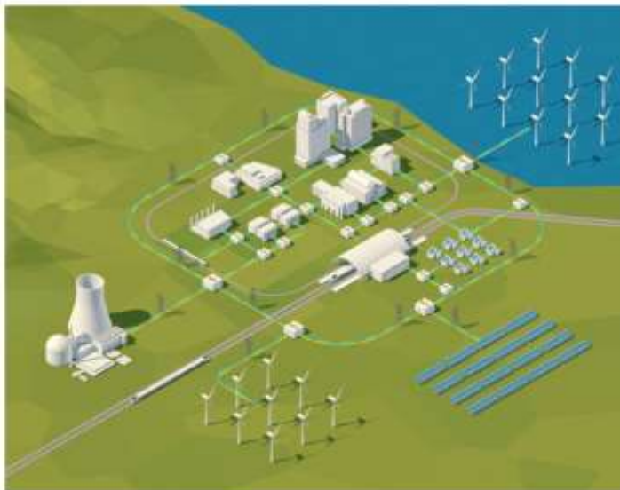
Bild: : Im Smart Grid kommunizieren Erzeuger, Speicher, Verbraucher und Verteilnetz miteinander, um Erzeugung und Verbrauch von elektrischer Energie stets in der Waage zu halten.
